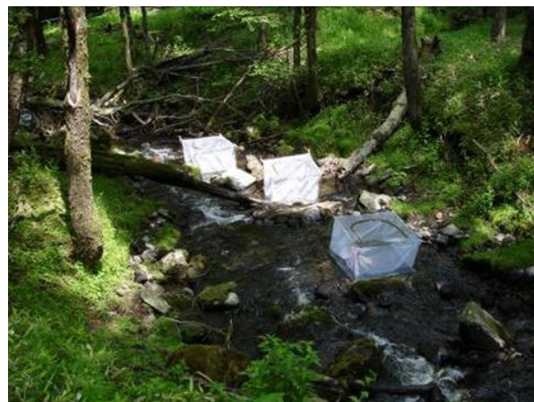
図 4. 天然魚と養殖魚との競争関係を調べる目的に用いたエンクロージャー。
