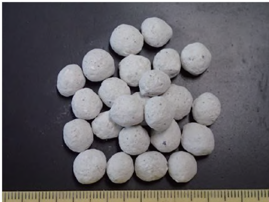
図 3-9. カキ殻加工固形物「ケアシェル」(左) とケアシェルを収容した養殖カゴを使った潮間帯採苗の様子(右) .
