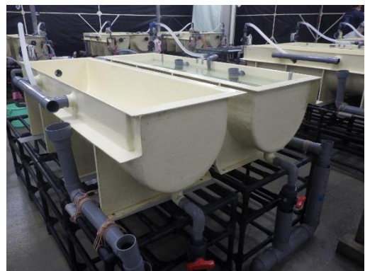
図 1. 新しいウナギ種苗量産水槽
