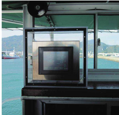
魚見台に設置された見える化装置のタッチパネルディスプレイ
