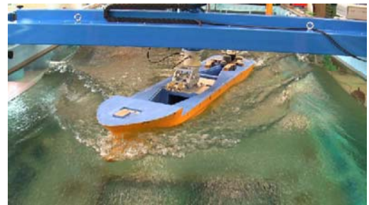
船体付加物の省エネ構造と 回流水槽での操作性実験
