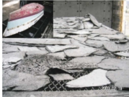
FRP 廃船と裁断・炭化処理後の FRP
