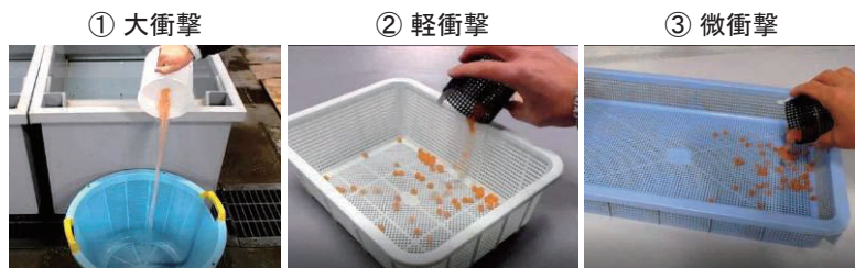
図 3. 落下衝撃を卵に与えた 3 通りの方法（①大衝撃：1 リットルの水と一緒に 60 cm 落下、②軽衝撃：高さ 10 cm の落下、③微衝撃：高さ 6 cm の落下）
