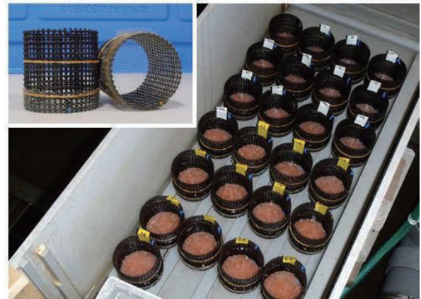
図 4. (上) 卵を 100 粒ずつ入れたカゴ トリカルネットと排水ネットで作成。200 粒の場合は別の角カゴ (約 21 cm×17 cm) を使用した。 (下) ふ化槽内で管理中の試験群 卵はカゴに入れたまま浮上期までふ化槽内で管理した。 なお、ふ化以降はシートを被せて遮光した。
