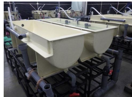
図2 新たな量産用水槽(ハーフパイプ型)
